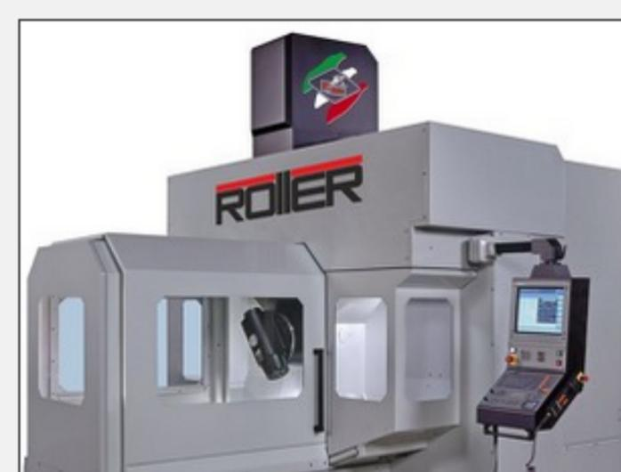
Mit Fräsmaschinen für die Großteilbearbeitung will Parpas anspruchsvolle Käufer auf der EMO 2013 überzeugen. Besonderes Merkmal der italienischen Maschinen ist das thermische Management, das optimale Genauigkeit bei der Bearbeitung gewährleisten soll.
