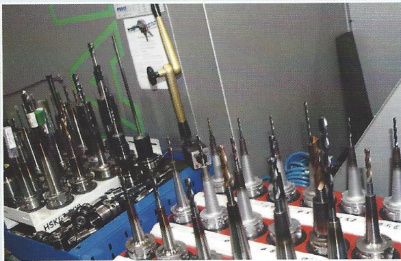
Die Spindel der Parpas Diamond Linear nimmt Werkzeuge mit HSK-36A-Schnittstelle auf.
