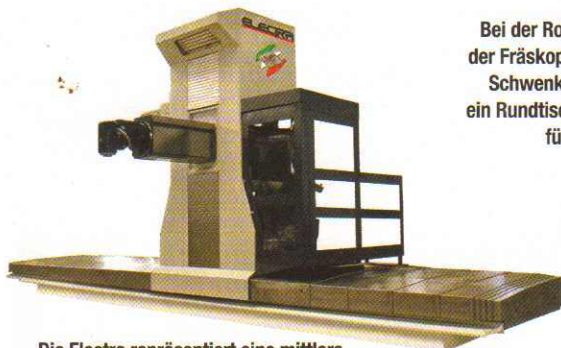
Die Electra repräsentiert eine mittlere Baugröße unter den Fahrständermaschinenbaureihen bei Parpas. Sie bietet Verfahrwege von bis zu 20 000 x 2600 x 1400 mm.
