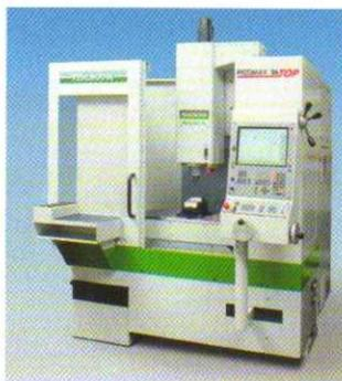
hain-Steuerung vom Typ TNC 620, eine flüssigkeitsgekühlte, drehmomentstarke Fehlmann-Motorspindel für das universelle Fräsen bis  $12000 \text{ min}^{-1}$  sowie ZS-interpoliertes Gewindecnenden, 3D-Fräsen, Ausdrehen et cetera.
