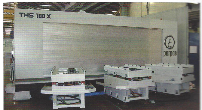
Bild 5: Die 3. Palette kann zum Puffern von Arbeit, aber auch zum Einsteuern von „Schnellschüssen“ verwendet werden (Werkbilder: Pappas Deutschland GmbH, Hamburg)
