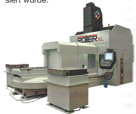
Bild 4: Die Paletten werden stirnseitig geladen und lassen die Bediener-/Beladeseite frei
