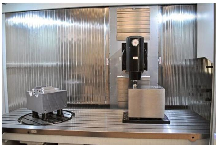
*Die großflächig verglaste Kabine ist mit einer von außen zu öffnender Schiebetür ausgestattet, die den vollen Zugang zum Arbeitsbereich ermöglicht und das Be- und Entladen der Werkstücke erleichtert.*
