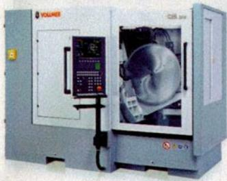
Die automatische Schärfmaschine CM 200 von Vollmer schärft Kanten von HW-Kreissägezähnen an Span- und Freiflächen und in der Version CMF 200 die Flanken. Die Präzision und die Bearbeitung in einer Aufspannung ermöglichen laut Hersteller neun CNC-Achsen. Die
