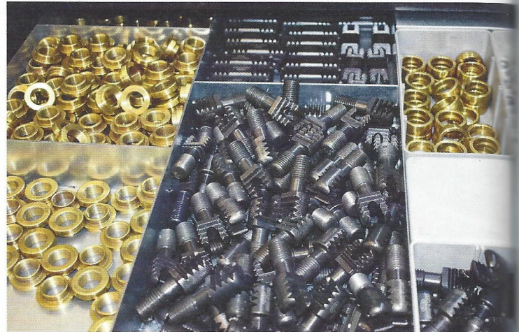
Baukasten FCS: Das FCS-Nullpunktspannsystem Breyll-Line besteht aus Säulen, Ringen und Bolzen. (© Pflagher/Pauser)
