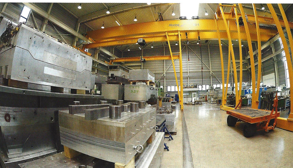
Großes Lager: Die bis zu 40 Tonnen schweren Prototypenwerkzeuge werden für die Kunden zwei Jahre lang gelagert. (© Hanser/Schröder)
