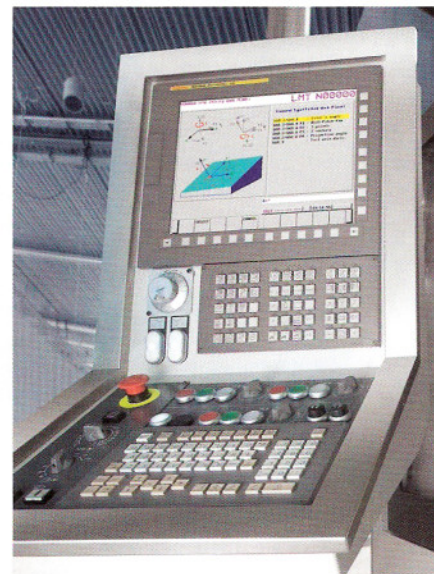
6 Bessere Oberflächenqualität, kürzere Zykluszeiten und erweiterte Sicherheit: Fanuc hat seine Highend-Steuerungen »30i-A« und »31i-A5« mit neuen Softwarefunktionen für die 5-Achs-Bearbeitung komplexer Werkstücke ausgestattet
