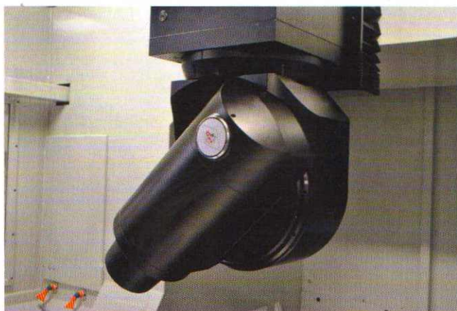
Bild 2: Zur Auswahl stehen verschiedene Spindeln mit Drehzahlen bis zu 22.000 U/min und Drehmomenten bis 117 Nm. Hierdurch sind sowohl Schlicht- als auch Universalbearbeitungen möglich
